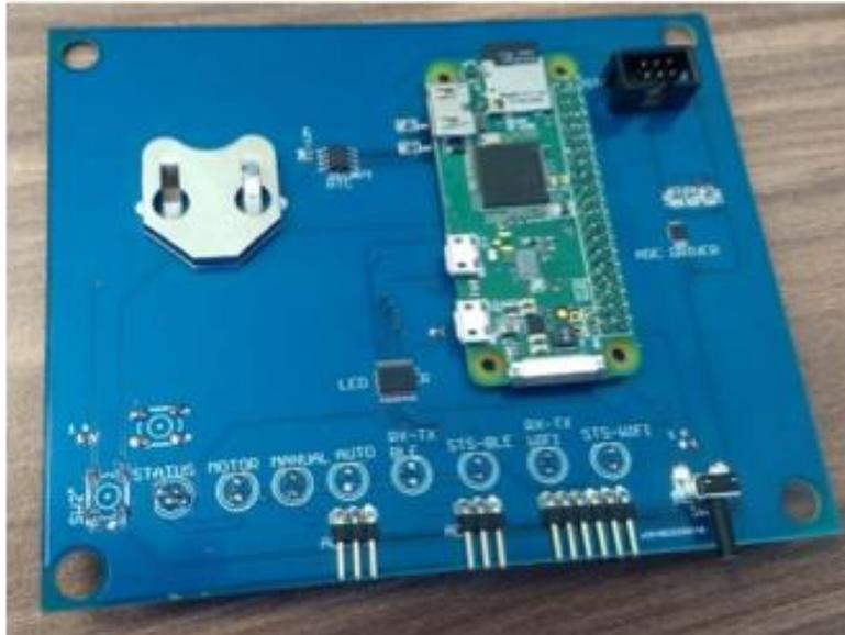
Figura 3.10 Controlador Digital para sistema de Aspersión
