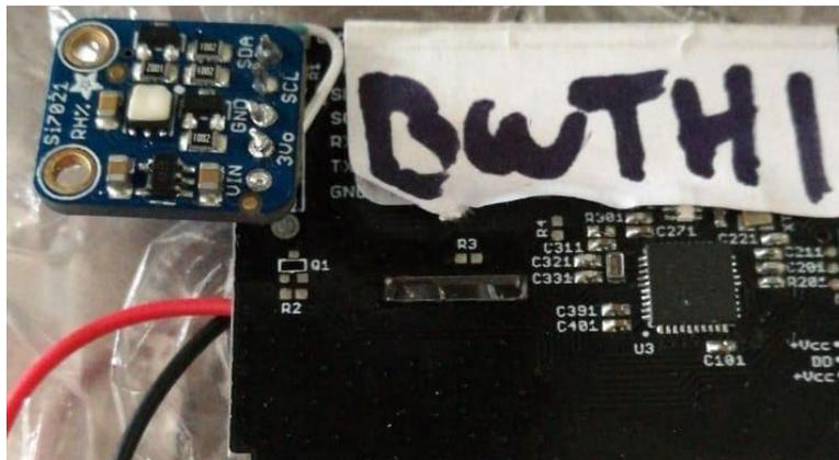
Figura 3.4 Módulo sensor BWTH1 con comunicación Bluetooth LE.
